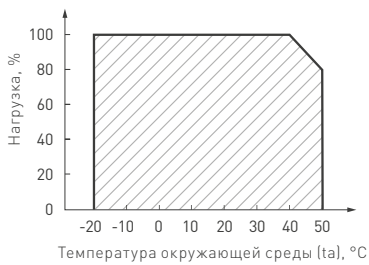
Рис. 2. Максимальная допустимая нагрузка, % от мощности источника.
